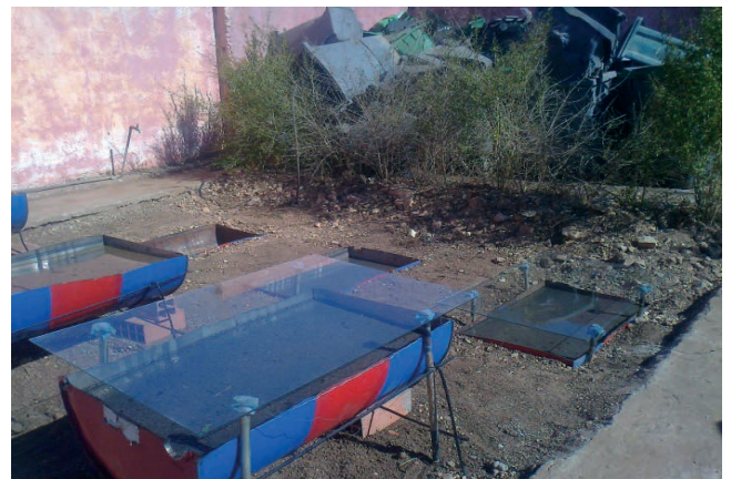
Figure 2 : Bacs d'évaporation enterrés ou hors sol, avec et sans vitre horizontale
