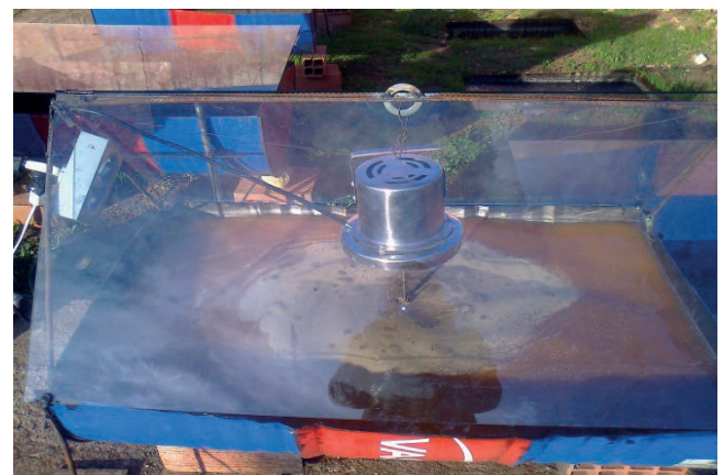
Figure 3 : Bac expérimental d'évaporation forcée couvert d'une vitre inclinée et équipé d'un dispositif d'agitation et ventilation
